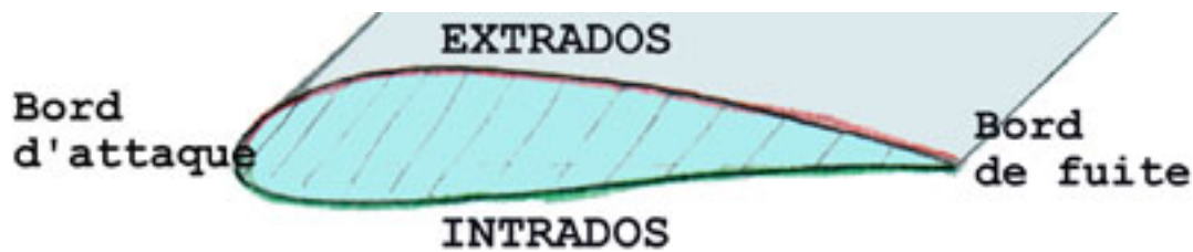
schéma 1: Aile en coupe
