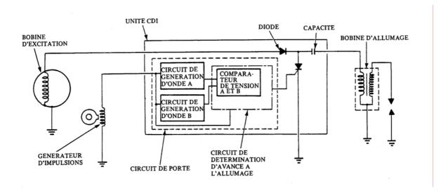
Le circuit d'avance à l'allumage convertit la sortie du générateur d'impulsion en onde A et B.
