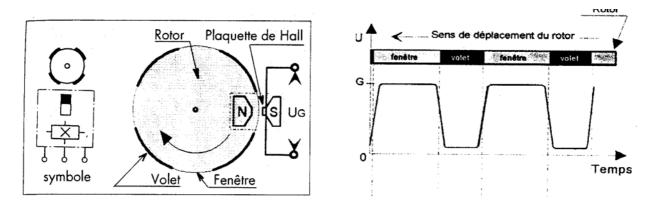
La tension devient nulle lorsque le champ magnétique est dévié par un volet.
