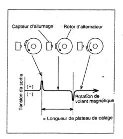
La tension aux bornes du capteur devient nulle chaque fois qu'une dent passe devant lui.
