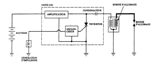
Le principe de fonctionnement est identique à celui du CDI.
